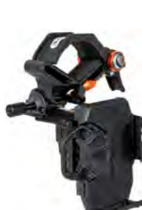
MX: V0001463 USA: 81057 KIT ADAPTADOR NEXYZ DX SMARTPHONE Rango de abrazadera del teléfono: 65 mm - 90 mm (2,55" - 3,54") Rango de abrazadera del ocular: 35 mm - 60 mm (1,37" - 2,36") Estilo de ajuste fino: Movimiento X, Y, Z: controlado por perillas con sistema de piñón y cremallera
